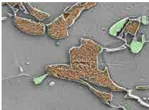
DP600 Stahl Mikroaufnahme, Bainit (braun) und Martensit (grün) Körner in einer ferritischen Matrix (grau) dargestellt. DP600 steel micrograph, showing bainite (brown) and martensite (green) grains inside a ferritic matrix (grey)
