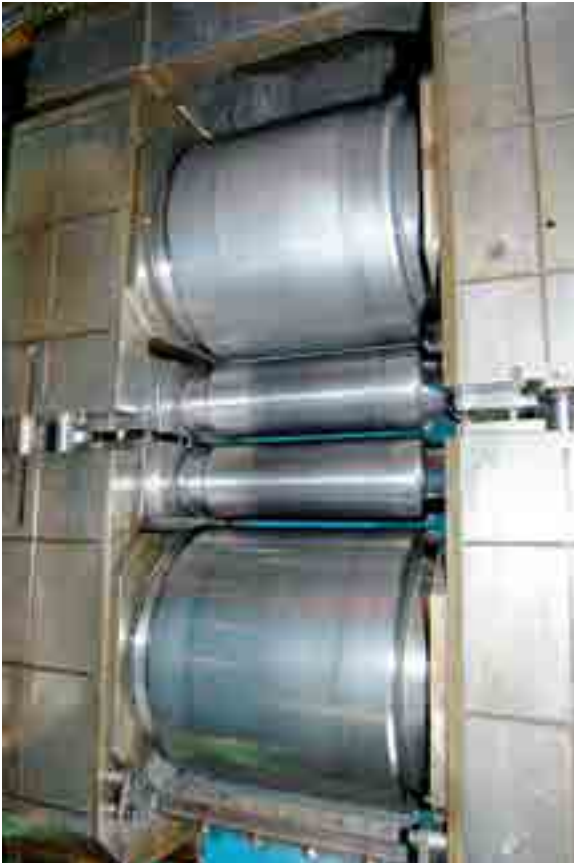
Arbeitsbereich von unserem 4-high Reversierwalzwerk Working area of our 4-high reversing mill
